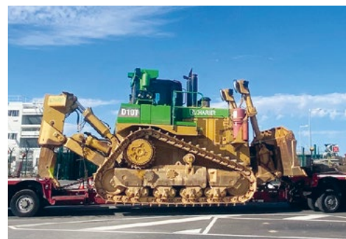
Le premier engin de chantier arrivé sur le site : un tracteur à chenille pour les opérations de terrassement.
